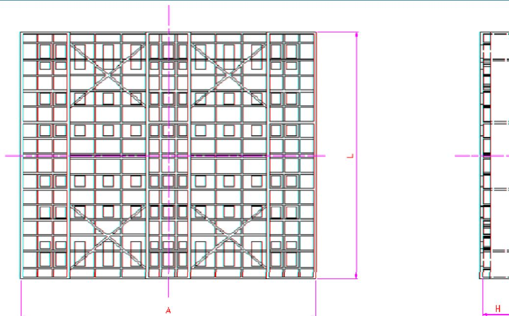
El ensayo practicado tanto en estática como en dinámica demuestra que el mayor cambio de flexión de la paleta se reporta en los primeros días de ensayo, valores que tienden a estabilizarse en los días siguientes y que se encuentran dentro de los valores críticos para Uniplast, garantizando un buen desempeño una vez en uso.
